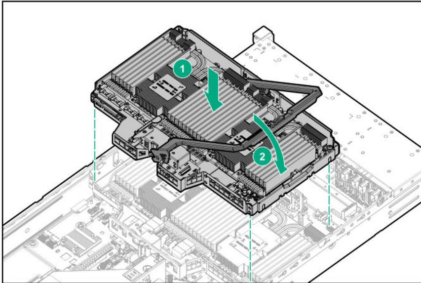
9. Install the air baffle (**Installing the air baffle** on page 58).
