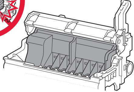
5 Coloque el cabezal de impresión en su sitio.
