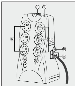
► Gniazda z filtrem ⑦ niezabezpieczone urządzenia podłączone do tych gniazd są zasilane od chwili, gdy przewód wejściowy ② jest podłączony do gniazda sieciowego. Przycisk ⑧ nie steruje tymi gniazdami.
