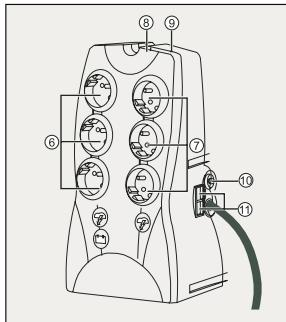
سكنر، فاكس...) بالأخذ **٧** المزود بفلتر وأجمي ضد التيار العالي. انظر الرسم **B**. ولا يكون هذا المأخذ مشحونة في حال انقطاع التيار الكهربائي.
