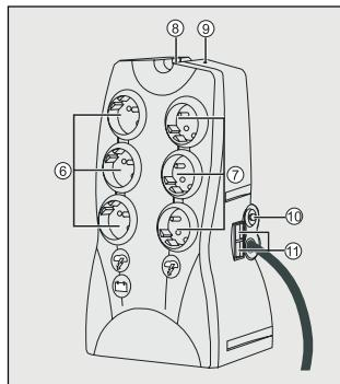
► **Розетки с аккумуляторной поддержкой (6):** Соединенные с этими розетками приборы запитаны, когда кнопка (8) нажата (положение включения) и ее зеленая подсветка горит (см. Рис. Е). Эти розетки можно включить, даже если АБП не соединен с сетью электропитания (при этом подсветка кнопки (8) мигает).
