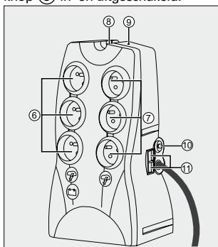
► **Battery backup-aansluitingen** (6): de apparaten die op deze aansluiting aangesloten zijn, krijgen stroom van zodra de knop (8) ingedrukt wordt (AAN) en groen oplicht (zie figuur E). Deze aansluitingen kunnen ook ingeschakeld worden als de **UPS** niet op de netspanning aangesloten is (knop (8) knippert).
